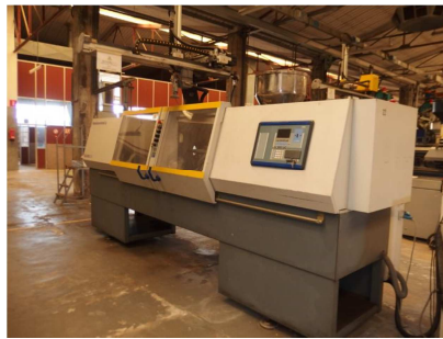
Inyectora termoplástico 100 ton.Robot Tecnomatic BATTENFELD BA 1000/500 CDK Ref: 17574
