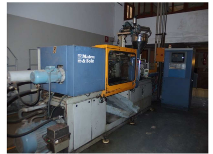
Inyectora termoplástico 90 ton.Sacacoladas Apex MATEU&SOLE METEOR 320-90 CEM-1B Ref: 17575
