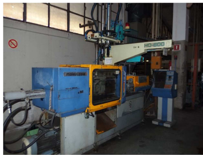
Inyectora termoplástico 55 ton.Robot YMA MATEU&SOLE METEOR 200-55 VISIOMET Ref: 17579
