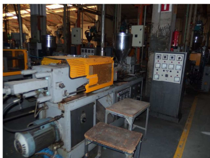
Inyectora termoplástico 40 ton. MATEU&SOLE METEOR 40 Ref: 17585
