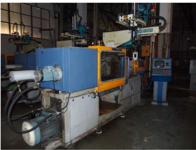
Inyectora termoplástico 90 ton.Robot YMA MATEU&SOLE METEOR 320-90 VISIOMET Ref: 17577
