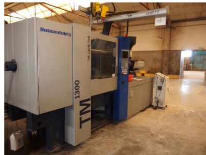
Inyectora termoplástico 130 ton.Robot Tecnomatic BATTENFELD TM 1300/750 Ref: 17568
