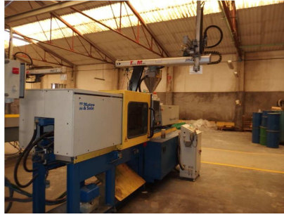
Inyectora termoplástico 90 ton.Robot Tecnomatic MATEU&SOLE METEOR 440-75-90 V2008 Ref: 17571
