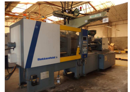
Inyectora horizontal 180 ton.Robot YMA BATTENFELD BK:T 1800/1200 Ref: 17569
